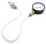
Импульсные и капиллярные линии используются для подключения оборудования к технологическому процессу, передачи давления к датчику удаленного монтажа в случаях:
