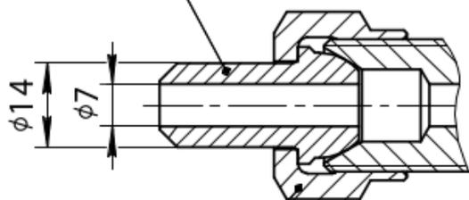
Гайка накидная M22x1,5
