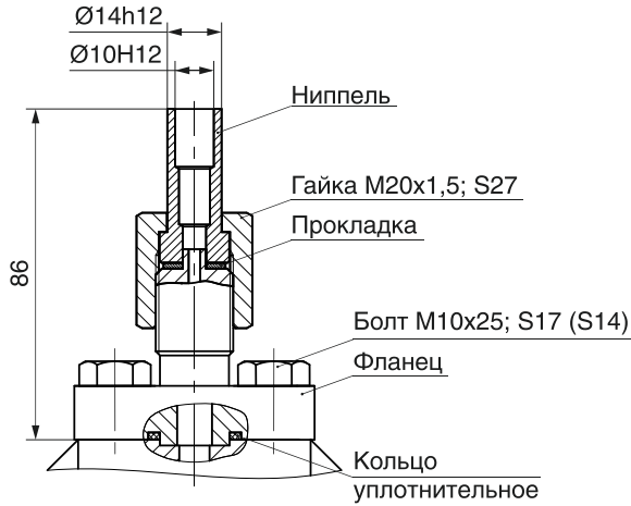
Рисунок Д.3 — Датчик с установленным ниппелем под накидную гайку M20x1,5 (в количестве 1 или 2 в зависимости от модели). Остальное см. рисунок Д.1.
